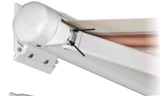
Einfache stufenlose Neigungswinkelverstellung über zwei Inbusschrauben am Seitenträgerdeckel. Bei Motorantrieb kann der Neigungswinkel von ca. 5° bis 60° und bei Kurbelantrieb von ca. 5° bis 35° eingestellt werden.
